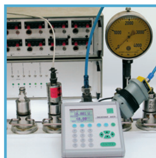
Comprobación de una instalación de presión
