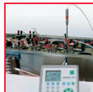
Medición de temperatura en baño de agua
