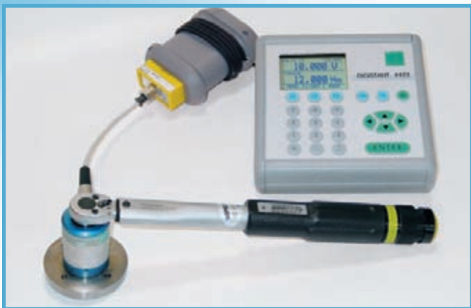
Medición de momento de par: La tolerancia del momento de par y la exactitud de repetición pueden determinarse de forma muy exacta con el DIGISTANT® junto con un sensor de momento de par Modelo 8628, al configurar el momento de par.
