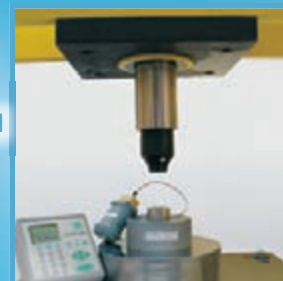
Calibración de fuerza de una prensa
