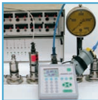
Comprobación de una instalación de presión
