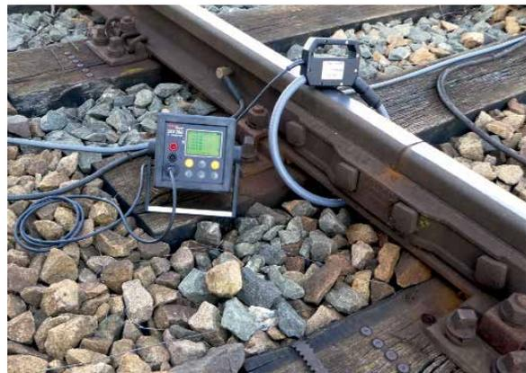
Corriente en la falta de circuito de vía sobre la junta aislante de carril
