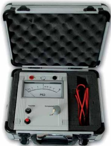
El Medidor de derivación a tierra **EMG 98-2** determina la resistencia de corriente continua a tierra de instalaciones eléctricas y circuitos eléctricos en redes CC (12 V ... 136 V) y en redes CA (hasta 750 V).
