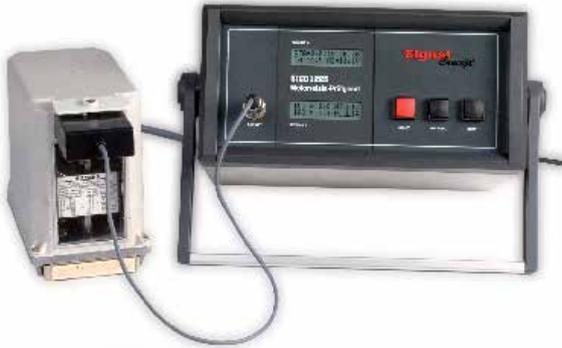
El Medidor para relé motor **SICO 1225** compruebe los relés motor de dos capas y de tres capas del tipo Siemens. La medida se realiza completamente automática. La pantalla LCD indica el factor de desexcitación así como todos los resultados.
