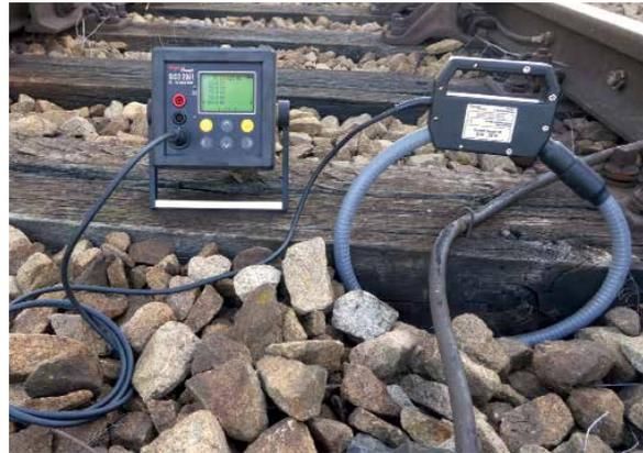
Ningún corriente de circuito de vía sobre la junta eléctrica de separación
