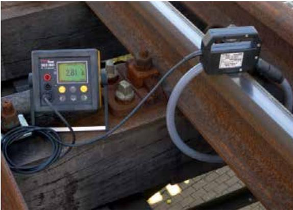
Localización de errores, ensayo de aceptación e inspecciones a circuitos de vía
