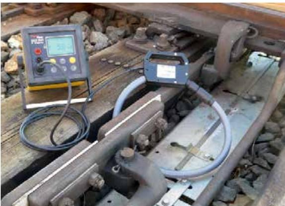
Corriente en la falta de circuito de vía sobre el vástago del distribuidor
