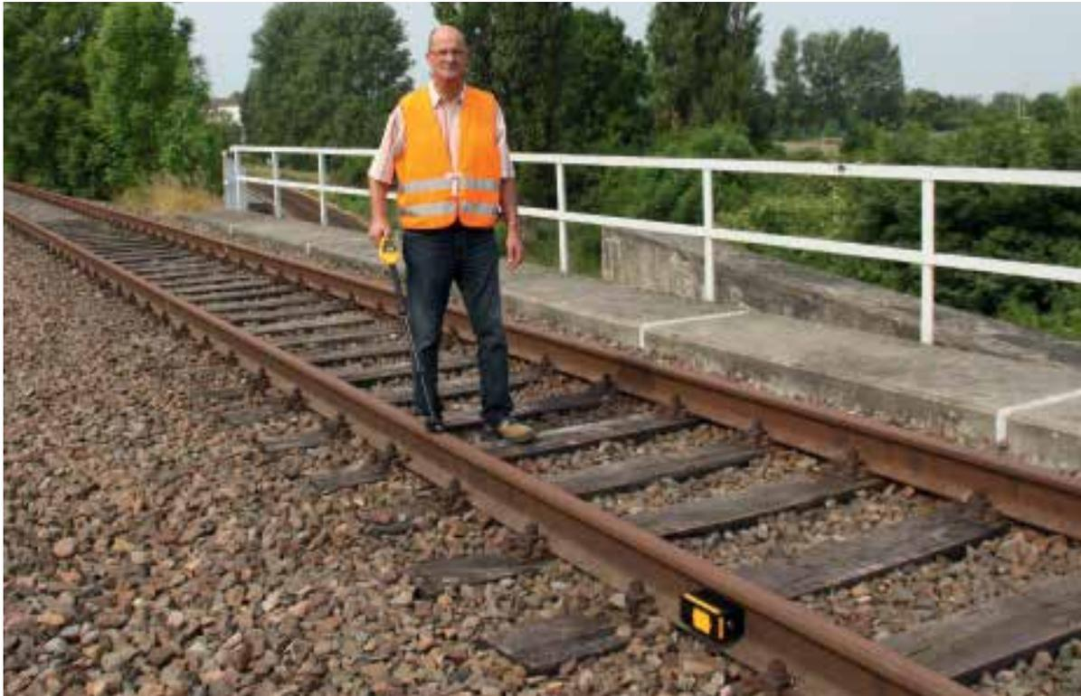
El Localizador para errores en aislamientos y contactos **SICO 3017 ISKO** posibilita la localización de errores eléctricos, que normalmente se encuentra muy mal. Mide el corriente con alta selectividad en frecuencia y sin contacto. No se necesita deshacer los conductores o descargar los sistemas de señales si no se utiliza las señales de los circuitos de vía en marcha.
