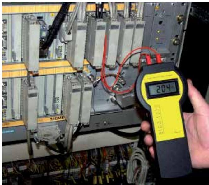
El Aparato de ajuste para bobinas de acoplamiento de trenes **SICO 1230** es un medidor de tensión para el ajuste de bobinas de acoplamiento de vehículos ZUB de los sistemas ZUB 100 y ZUB 200 en el área de frecuencia de 50 kHz a 100 kHz.
